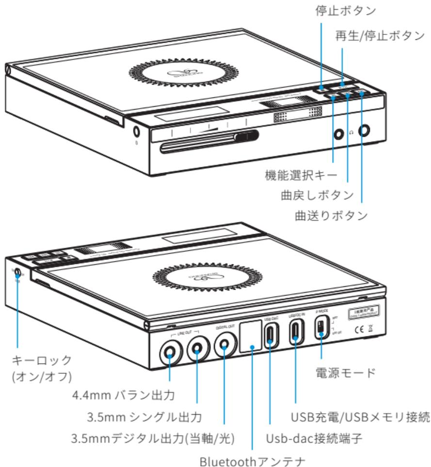
3.5mmデジタル(光デジタル/同軸)出力: これは光デジタル/同軸の2in1端子で、3.5mmプラグの光デジタルケーブルまたは同軸ケーブルを通じて外部のデコーダー機器に接続します。
