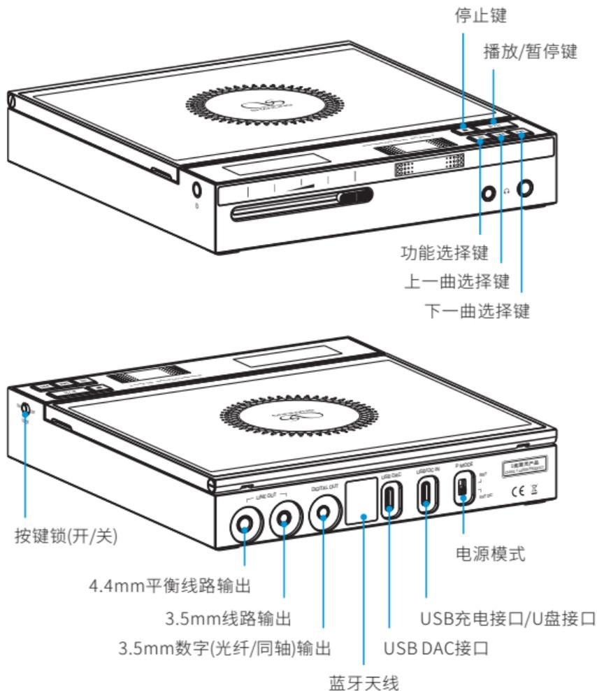
**3.5mm数字(光纤/同轴)输出:** 此为光纤/同轴二合一接口，通过3.5mm插头的光纤线或同轴线可连接到外部的解码设备，以获取更高音质的音乐信号。
